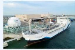
▲日本製鋼所での液化水素サプライチェーン構築に向け神戸商港に建設した、業界初の液化水素貯蔵・輸送船と液化水素供給船「すいしんらんていあ」
